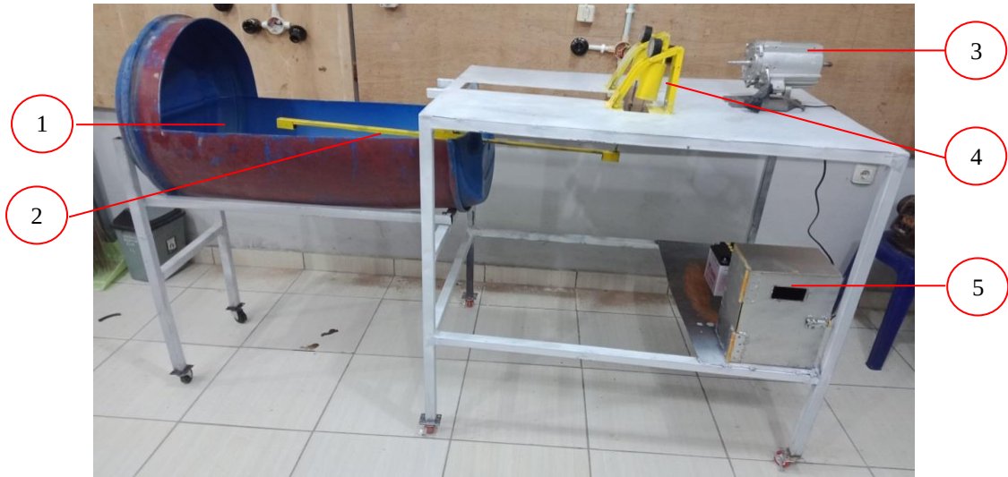
Gambar 19 Pembangkit Listrik Tenaga Gelombang Laut Menggunakan Pompa Angin
